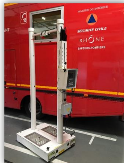
Portiques de détection radiologiques
